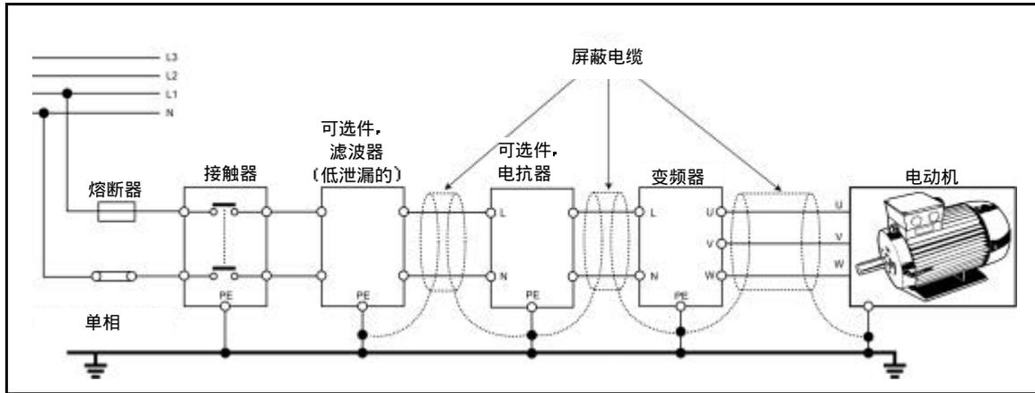
图 2-9 电动机和电源的接线方法
