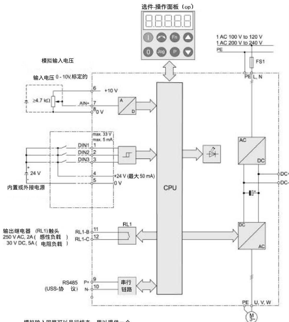
模拟输入回路可以另行组态，用以提供一个附加的数字输入 (DIN4)，
