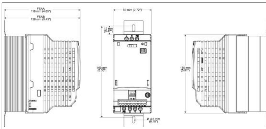
图 2-4 MICROMASTER 410 变频器的外形尺寸
