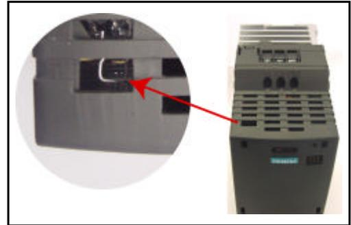
图 3-4 改变供电电源的频率
