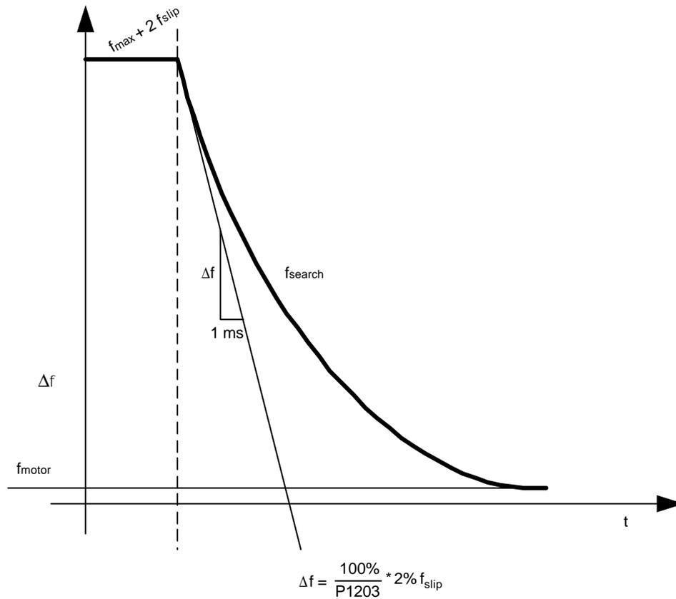
搜索时间是指, 从 f\_max (最大频率) + 2 x f\_slip (滑差频率) 到 0 Hz 的全部频率进行搜索所要经过的时间。
