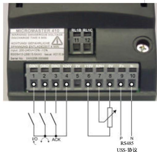
图 3-1 变频器的方框图
