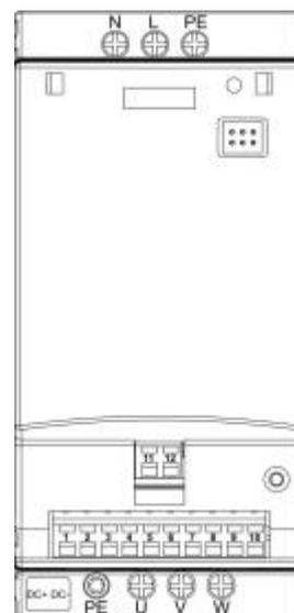
图 2-8 MICROMASTER 410 变频器的接线端子
