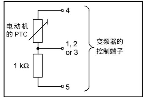
图 3-8 电动机过载保护的 PTC 接线
