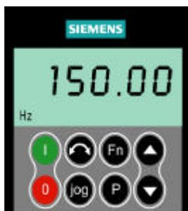
用户可以通过操作面板 (OP) 访问变频器的参数，还可以对 MICROMASTER 410 变频器的参数进行设置。一台 OP 可以对若干台 MICROMASTER 410 变频器进行组态。方法如下：在一台变频器上用 OP 设定需要的参数，完成设定以后，将 OP 拆卸下来，装到下一台变频器上并进行设定。
