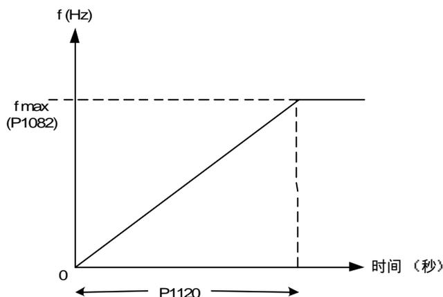
如果设定的斜坡上升时间太短, 就有可能导致变频器跳闸 (过电流)。
