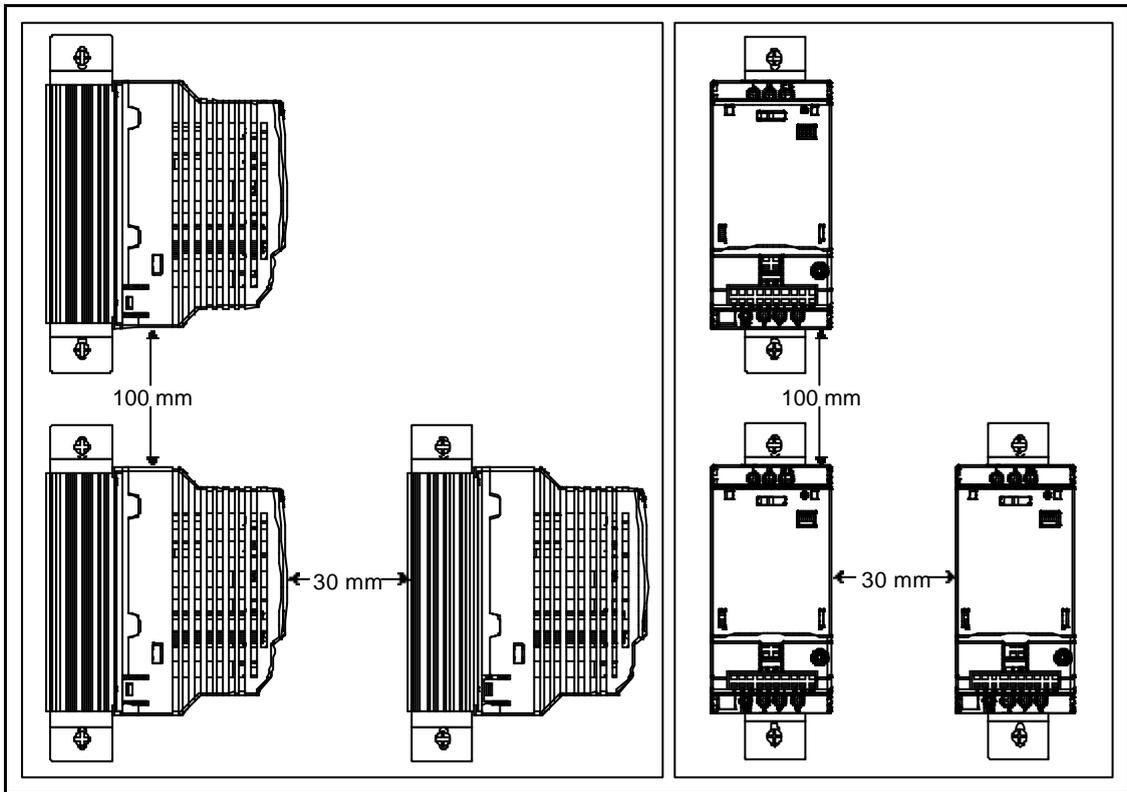
图 2-5 MICROMASTER 410 变频器间的安装间隙
